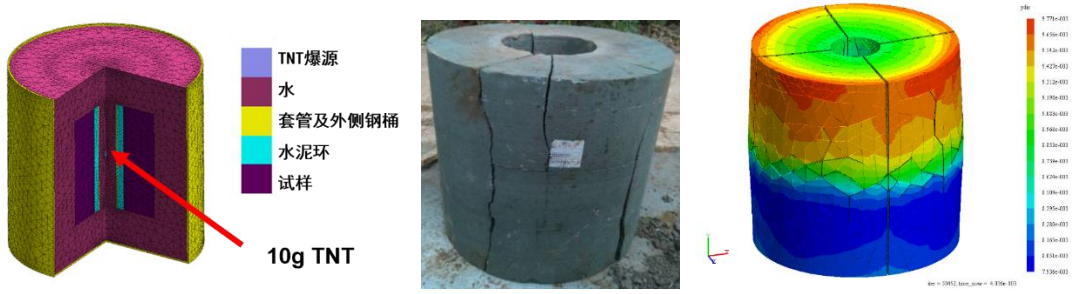
图 6.4 圆柱试样爆炸破裂过程模拟
